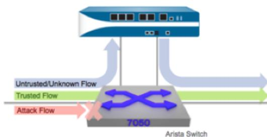
Файервол фиксирует DDoS атаку и по syslog передает команду на блокирование вредоносного трафика коммутатору Arista
